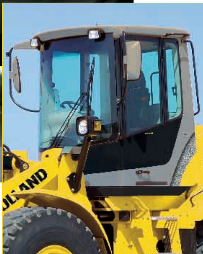
■ ROPS/FOPS Kabine, Dynamische Stabilität, Freie Sicht nach allen Seiten, Notlenkeigenschaft, LTS Laststabilisator, Straßenzulassung.
